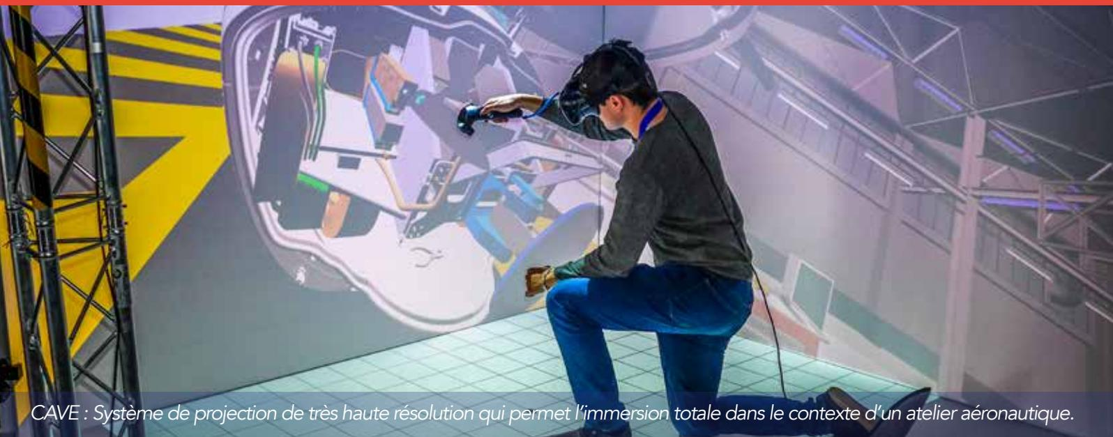
CAVE : Système de projection de très haute résolution qui permet l'immersion totale dans le contexte d'un atelier aéronautique.
